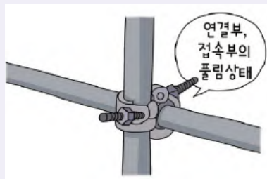
해당 비계의 연결부 또는 접속부의 풀림 상태
