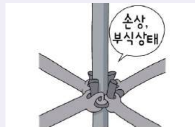
연결 재료 및 연결 철물의 손상 또는 부식 상태
